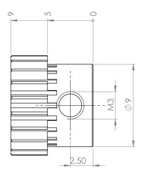
Bezugsprofil: DIN867 ENTGRATEN UND SCHARFE KANTEN BRECHEN mit 0,1 mm Fase
